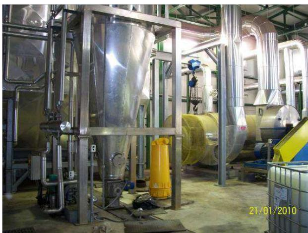
**sanificatore fanghi: separatori fango, tamburo di essiccamento e tubazioni di collegamento**
